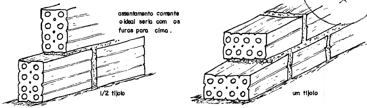
Figura 1 - Execução de alvenaria utilizando tijolos furados.
