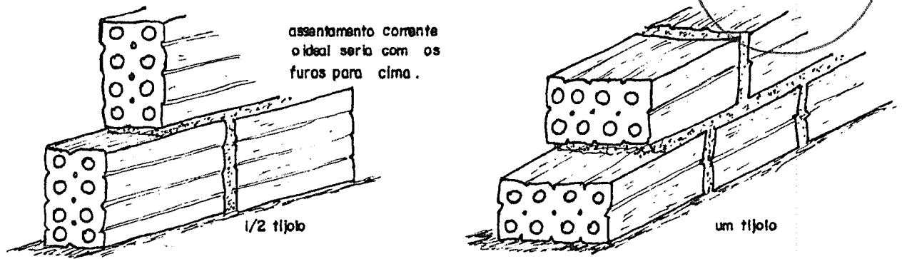
Figura 1 - Execução de alvenaria utilizando tijolos furados.
